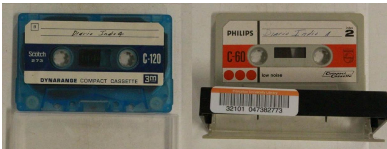
Figura 4 Casetes en los que Sarduy realizó la grabación en la India en 1971. El de la marca Scotch, de 120 minutos, es de fabricación americana y se comenzó a comercializar en 1969. Philips fue la primera en patentar esta tecnología, que se introdujo en la radio alemana en 1963 y se comercializó en Europa a partir de 1965. El usado por Sarduy es de 60 minutos.
